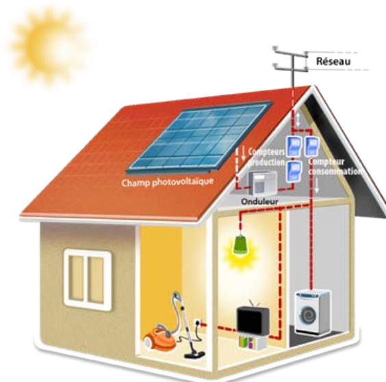
Installation photovoltaïque avec vente totale de l'électricité ©HESPUL
